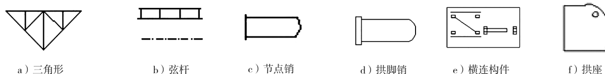
图1 钢拱架组装构件
