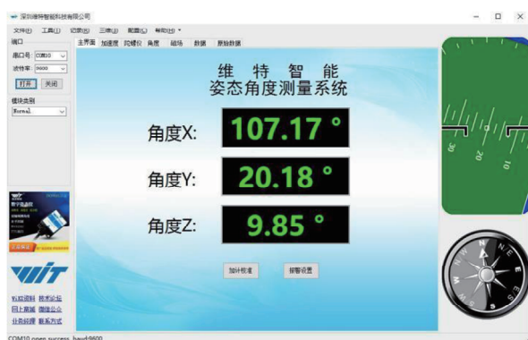
图1 边坡形变在线监测系统
