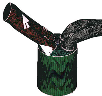
图2 发动机进、排气缸内计算区域网格划分结果
