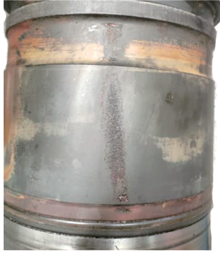
图 1 气缸套主推力侧穴蚀现象
