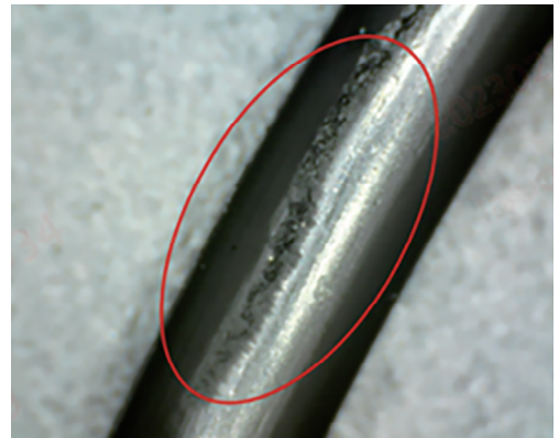
图2 密封圈破损故障现象
