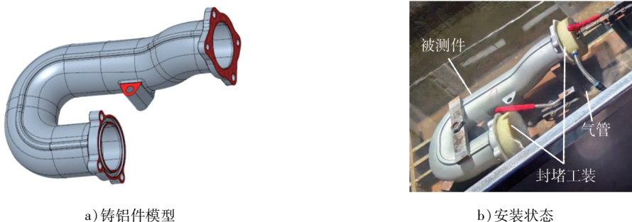
图 2 铸铝件模型及其检测时的安装状态
