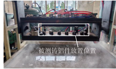
图7 高温水检法气密检测装置
