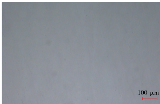
图10 改进后连杆非金属夹杂物检验情况
