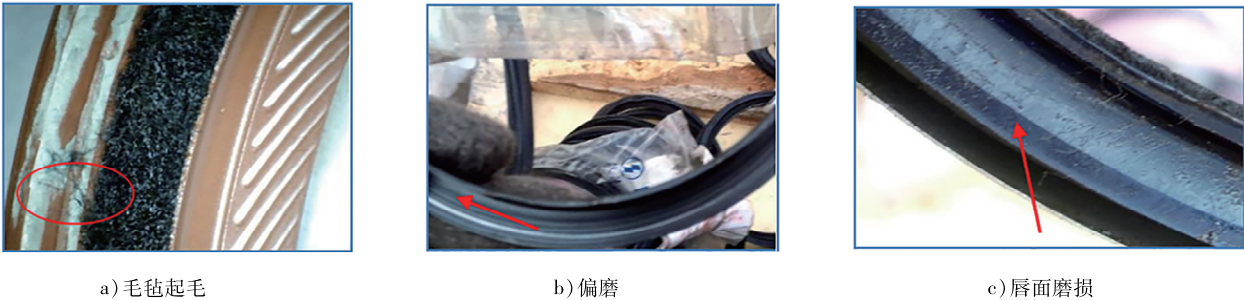
图 2 油封故障现象
