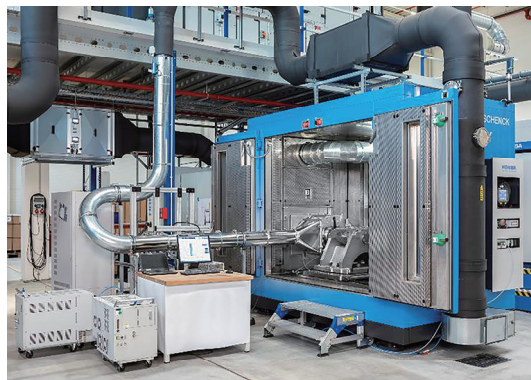
图 11 制动排放颗粒物测量实验室布局
