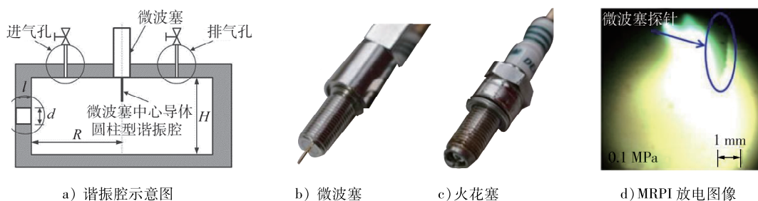
图8 微波谐振点火
