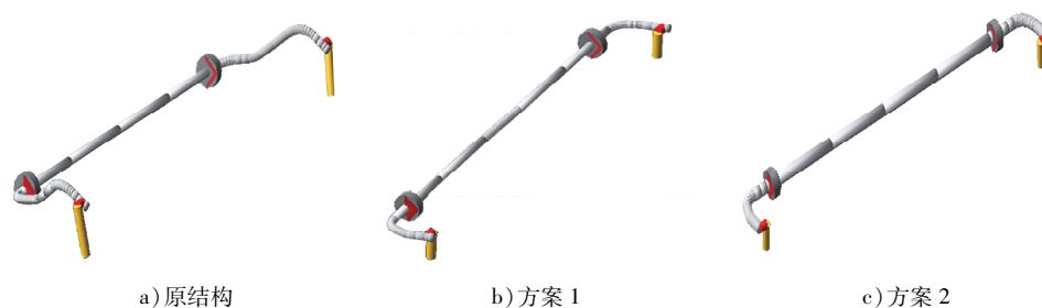
图6 横向稳定杆优化前、后结构对比图
