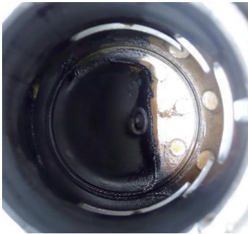
图 9 优化扫气道、点火位置后耐久试验燃烧室外观
