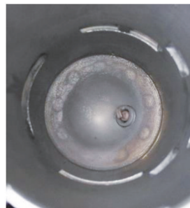
图 13 优化挤流层和面容比后耐久试验燃烧室外观
