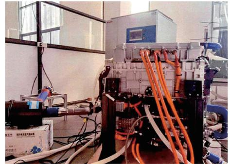
图3 燃料电池发动机系统台架图
