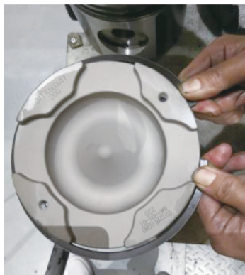
图2 活塞环手动装配过程示意图
