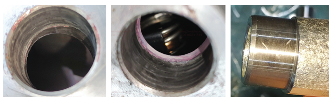
a) 环状退刀纹 b) 起皮、划伤 c) 缺少密封胶
