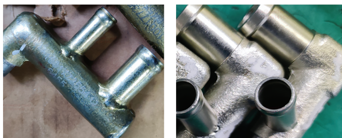
a) 焊接管接头 b) 锻造管接头
