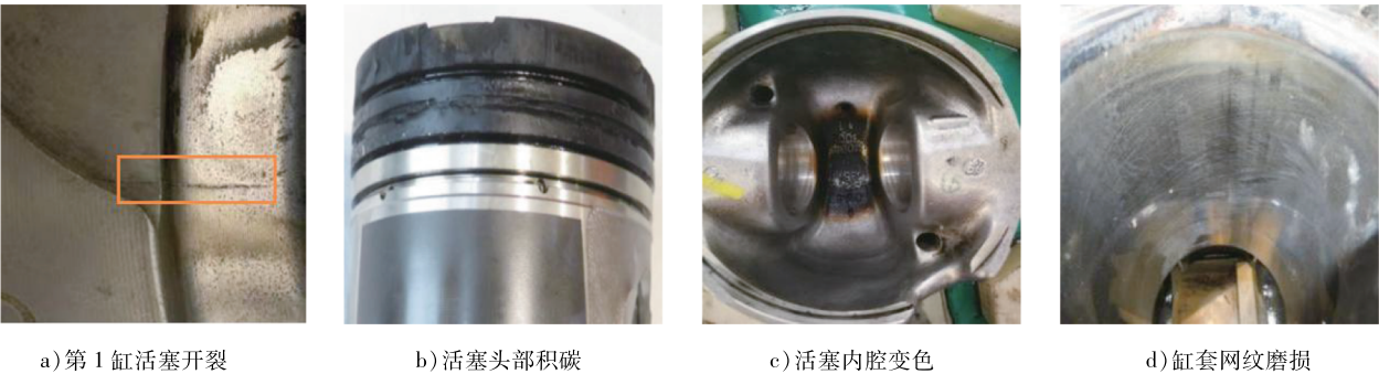
图 1 某轻型柴油机活塞故障现象
