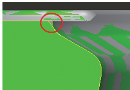
图9 优化后燃烧室和避阀坑相交处形状
