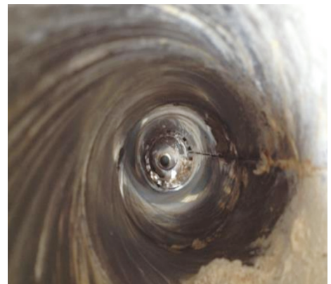
图 9 SUS444 耐腐蚀测试结果
