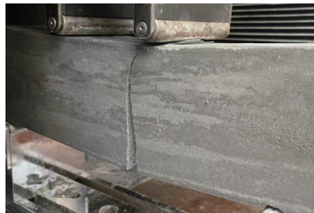
图6 普通泡沫轻质土的破坏形态
