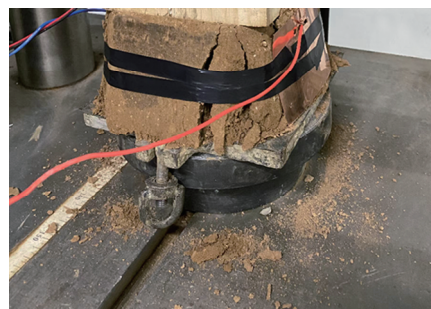
图6 试件土体破坏
