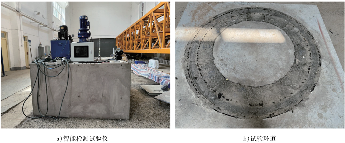
图 1 铺面长期性能智能监测设备
