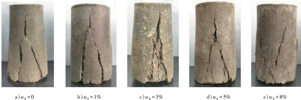
图 4 不同含盐量下污染土试样的破坏形态
