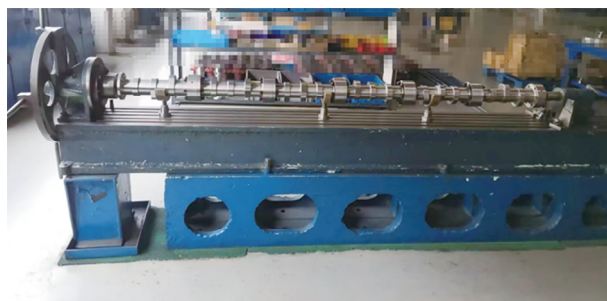
图8 装配后的凸轮轴状态
