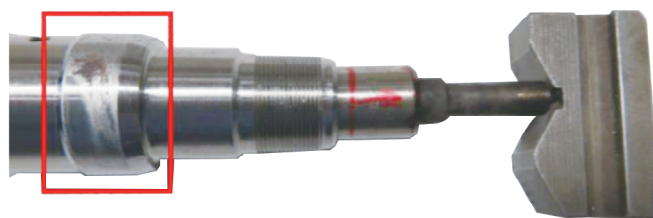
图6 故障喷油器磨损情况
