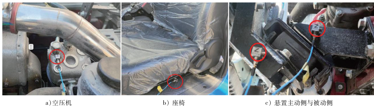
图1 振动传感器布置位置图
