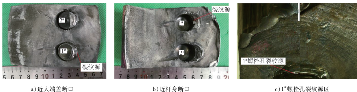
图3 连杆处断口宏观形貌
