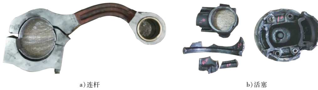
图1 连杆、活塞开裂情况
