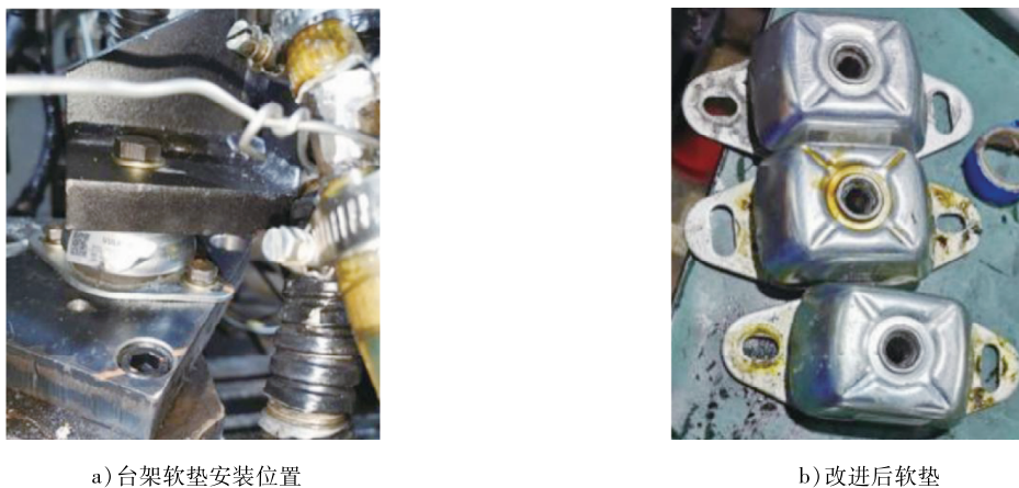
图9 软垫在台架上的安装位置及改进后的软垫图
