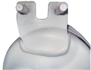
图9 优化方案二支架GED试验后状态
