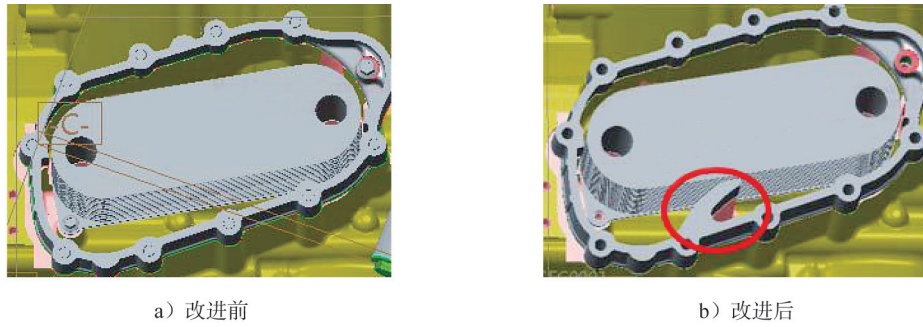
图5 改进前、后油冷却器三维模型
