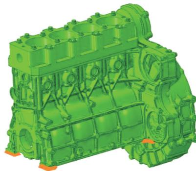
图2 柴油机有限元模型
