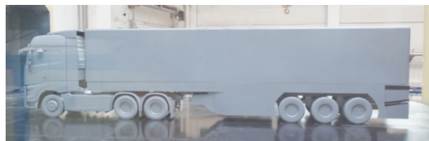
图1 重卡风洞实验模型
