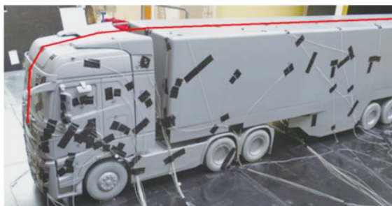
图3 压力因数测点布置
