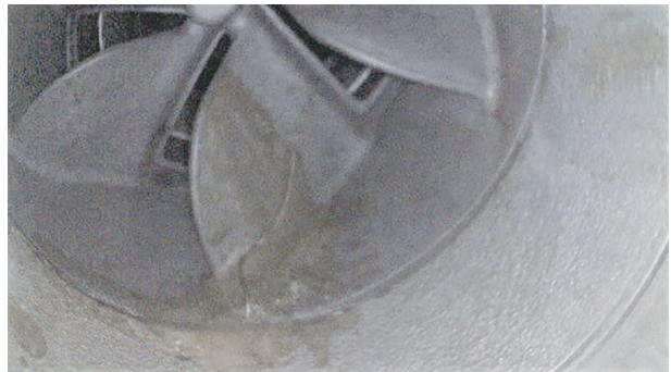
图 12 综合工况带加热水道的 EGR 混合器外观
