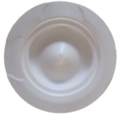
图6 顶面隔热涂层钢活塞
