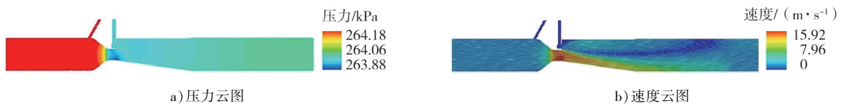
图6 优化喉口直径 d 的文丘里管流动压力和速度云图仿真结果
