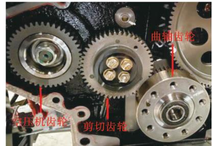
图7 剪切齿轮方案布置
